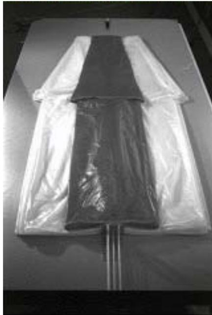
**6.** An der Stempelbahn wird nun der Basis- und Oberkappenrand symmetrisch zur Kappenspitze gezogen, so dass mauartige Öffnungen entstehen. (Dadurch wird eine schnelle Öffnung des Gerätes ermöglicht)
