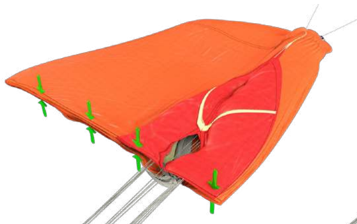
Figure 19 – Préparation du pliage en S du côté gauche en haut.
