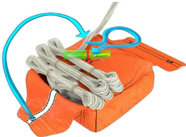
Figure 26 – Boucles à l'intérieur, prêtes pour le rabat final.
