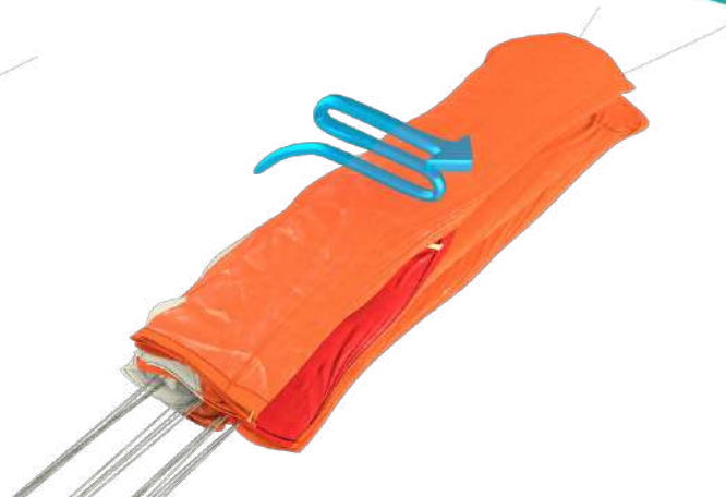
Figure 20 – Le pliage en S terminé.
