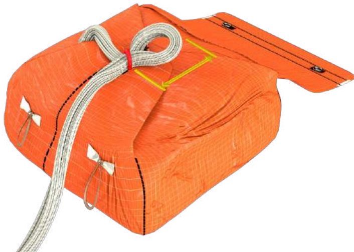
Figure 28 – Mets les suspentes lovées à l'intérieur et vérifie la longueur de la boucle de fermeture.
