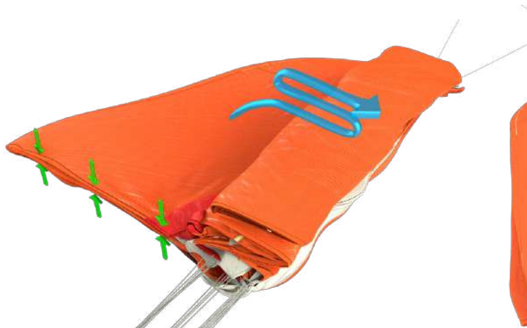
Figure 17 – Partie du dessous pliée en S au-dessus.
