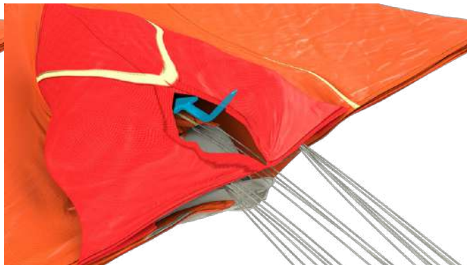
Figure 14 – Apex repliée au milieu des suspentes centrales.
