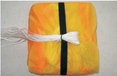
5.13. Auf einem von den Innencontainer-Klappen befindet sich eine Gümmschläufe, die zu dieser Kläppe befestigt ist. Schließen sie die Kläppen beginnend von der gegenüberstehenden Kläppe zur Kläppe mit der befestigten Gümmschläufe. Die Gümmschläufe wird durch die Osen an den restlichen Kläppen geführt, von unten aufwärts. Am Ende werden die Aufbäume durch die Gümmschläufe geführt, formend eine Leinen Schläufe von 3-5 cm.
