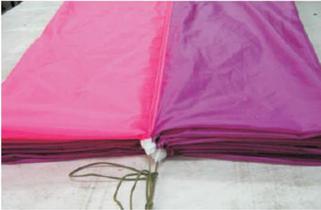
5.6. Vergewisseren Sie sich, dass jede Zelle richtig zusammengefaltet ist und die Nähte von jeder Zelle parallel verlaufen, sowohl dass sie gerade und leicht unter Zug sind. Um den gewünschten Effekt zu erzielen ist die Benutzung von kleinen Sändtäschen zu empfehlen.
