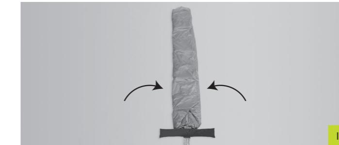
Plier la coupole en accordéon ou en forme de "S", de telle manière qu'elle s'ajuste à la mesure du pod. Si possible, ajuster les plis pour que ceux qui sont situés dans la partie inférieure soient plus courts que ceux de la partie supérieure. Il faut plier en quatre pour obtenir un paquet bien condensé. (Image J et K)
