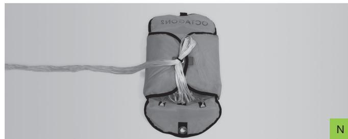
Ensuite, ranger le reste des suspentes selon une forme de "8" en groupes pairs, depuis l'intérieur du pod vers l'extérieur en fixant chaque extrémité aux élastiques. Les suspentes doivent conserver toujours la même tension. (Image O)
