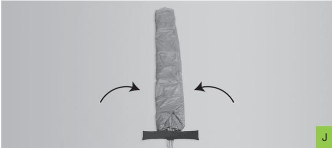
Falten Sie die Kappe in einer Ziehharmonika oder Z Form so dass sie in den Innencontainer passt. Wenn möglich passen Sie die Falten so an, dass sie unten etwas kürzer sind als am Scheitel. Der OCTAGON 2 passt am besten in den Container wenn Sie ihn 4 mal falten. (Bild K und L)
