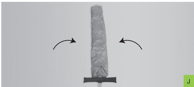
Plegar la campana en acordeón o en forma de "S", de tal manera que se ajuste a la medida del contenedor. Si es posible, ajustar los pliegues para que los que están situados en la parte inferior sean más cortos que los superiores. Se recomiendan 4 pliegues para un buen empaquetado. (Imagen K y L)
