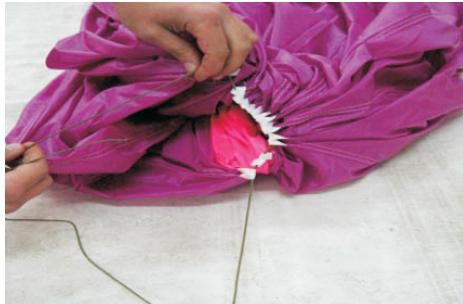
5.3. Fuhren sie eine Schnur durch die 18 Schlaufen in der Mitte von Nahten, die die Leinen verbinden, und befestigen Sie diese schnurr an einen fixen Gegenstand. Befestigen Sie den Hauptgurt eben so an einen fixen Gegenstand und spannen Sie die Leinen bis alle gerade sind mit dem Zug von etwa 5 kg.
