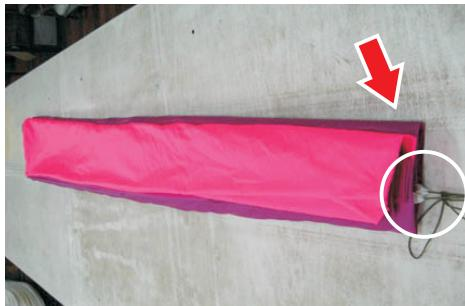
5.9. Lösen sie die Verbindungen von Fixierungsstellen am Hauptgurt und an der Kuppel, entfernen sie die Verbindungsschnur.
